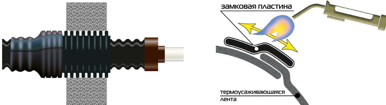
7.2.9. На образовавшийся стык накладывается, слегка нагретая желтым пламенем горелки, замковая пластина длиной 450 мм, как показано на рисунке. Пластина накладывается адгезивным слоем на поверхность ленты и прогревом горелкой приклеивается к ней.
