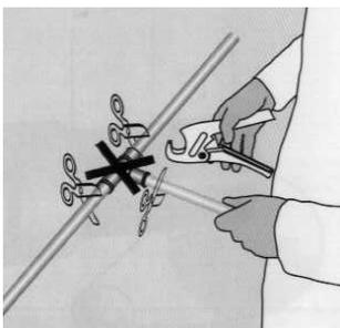
6.2.1. С помощью труборезных ножниц отделить от сети монтажное соединение (фитинг) вместе с подвижными гильзами.
