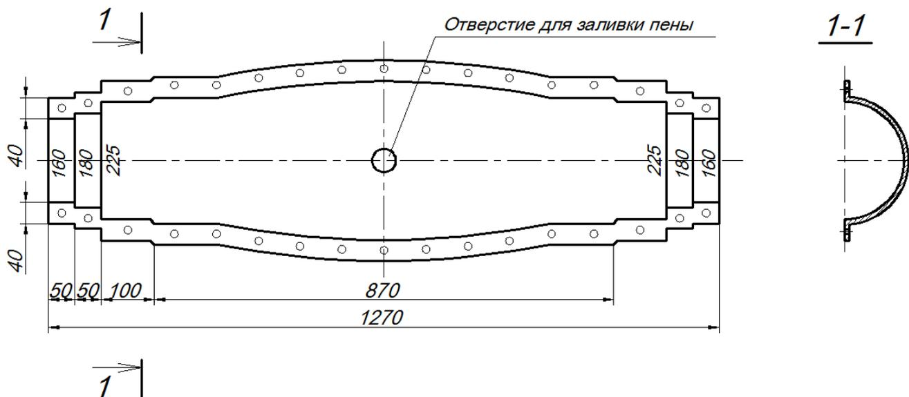
Рис. 16. Кожух для изоляции линейного стыка (для диаметров оболочек 160-225 мм)
