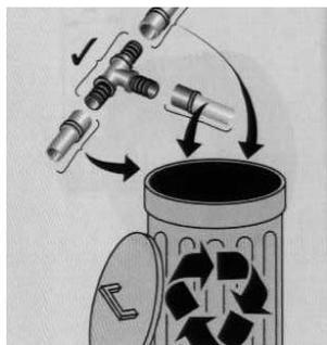
6.2.3. Снять подвижные гильзы со штуцера соединительного элемента (фитинга).
