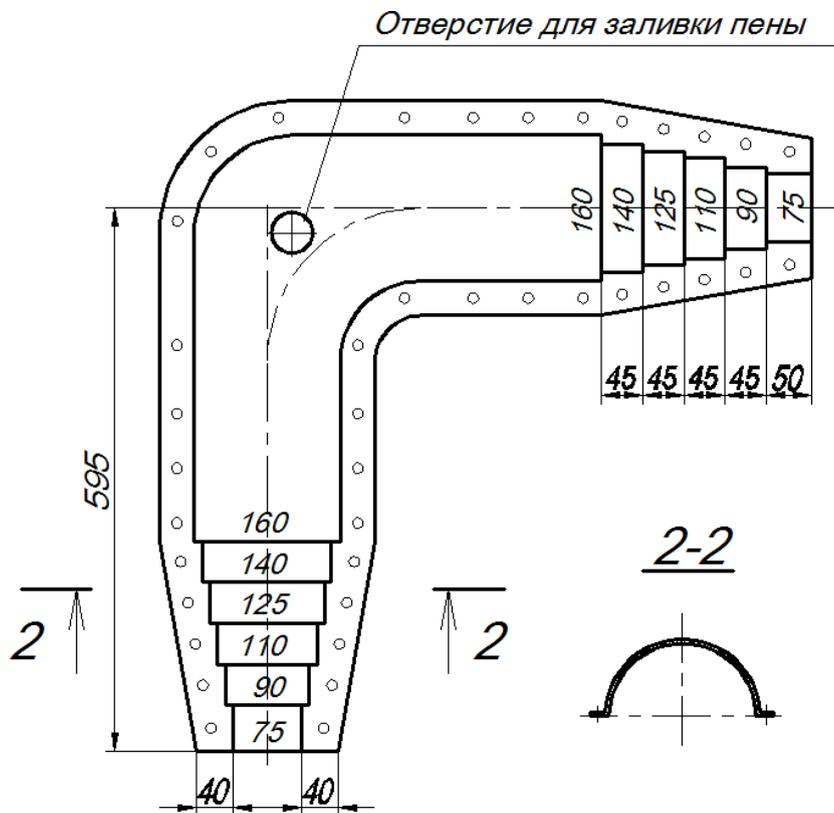
Рис. 15. Кожух для изоляции угольника, универсальный (для диаметров оболочек 90-160 мм)
