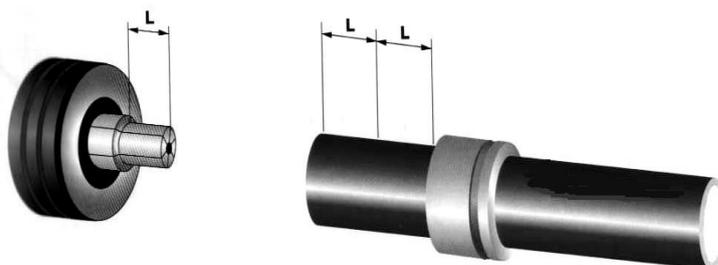
Рис. 22. Расстояние между торцом трубы и подвижной гильзой
