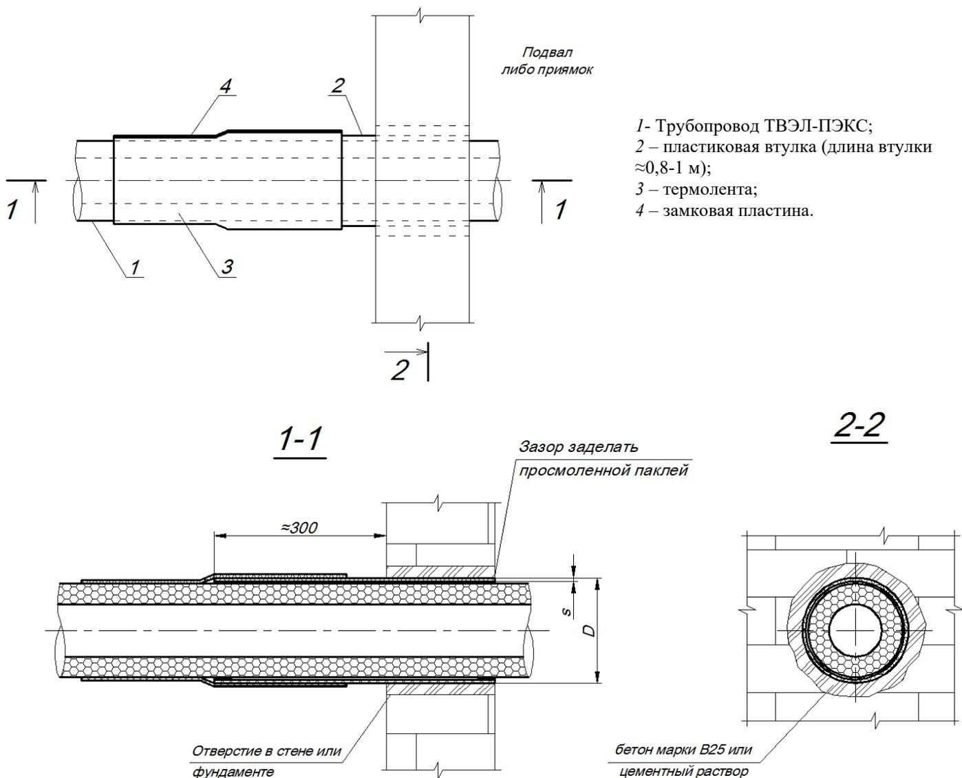
Рис. 19. Узел прохода через стену
