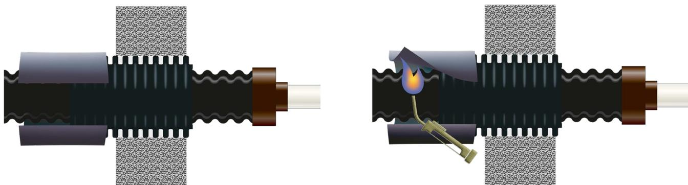
7.2.8. Термоусаживающаяся лента оборачивается вокруг места ввода трубопровода ТВЭЛ- ПЭКС во втулку, причем нахлест на втулку должен быть не менее 100 мм и не более 340 мм.
