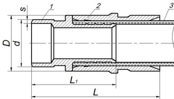
Рис. 7. Переход на сварное соединение с монтажной гильзой для труб ТВЭЛ-ПЭКС-К
