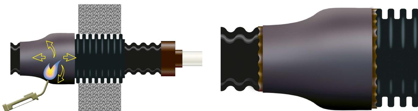
7.2.11. Критерием полной усадки манжеты является полное обжатие манжетой втулки и гидрозащитной оболочки трубы ТВЭЛ-ПЭКС (без вздутий, повреждений, пережогов) и вытекание сэвильенового подслоя из-под торцов манжеты на поверхность гидроизоляции и втулки по всей ее окружности.
