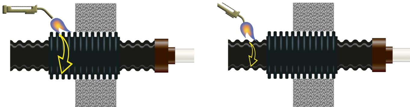
7.2.7. Прогреть полиэтиленовую оболочку трубы мягким пламенем горелки, плавными круговыми движениями, на расстояние не более 340 мм от края втулки. Температура, до которой необходимо греть гидроизоляцию трубы, не должна превышать  $+70^{\circ}\text{C}$ .
