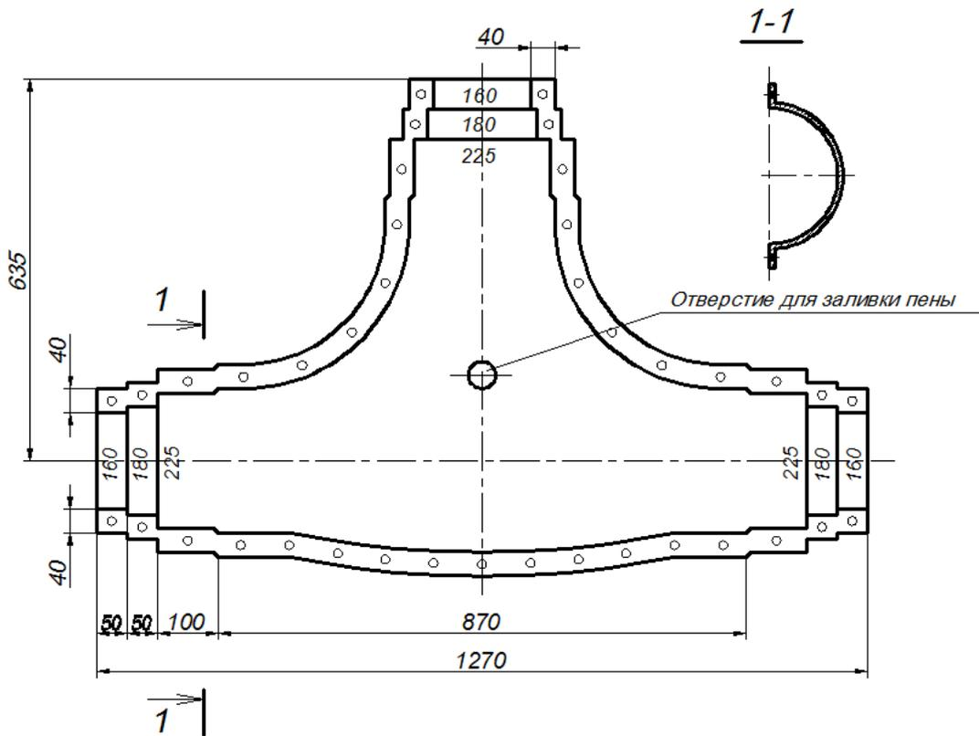
Рис. 12. Кожух для изоляции тройника (для диаметров оболочек 160-225)
