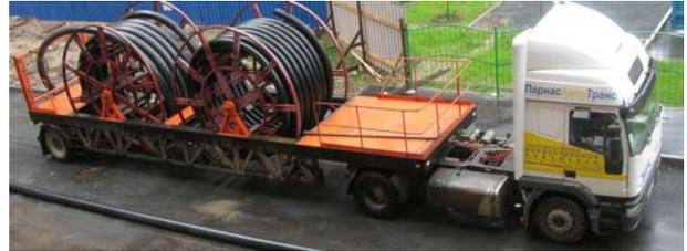
Трубопроводы в “бухтах” могут транспортироваться любым видом транспорта, обеспечивающим сохранность изоляции, в соответствии с правилами, действующими на транспорте. Погрузка, перемещение и разгрузка труб в бухтах должны производиться механизированным способом с применением специальных приспособлений, исключающих повреждение тепловой изоляции (мягкие стропы). При разгрузке “бухты” запрещается сбрасывать с машины, разгружать опрокидыванием. Запрещается перемещать “бухты” волоком.
