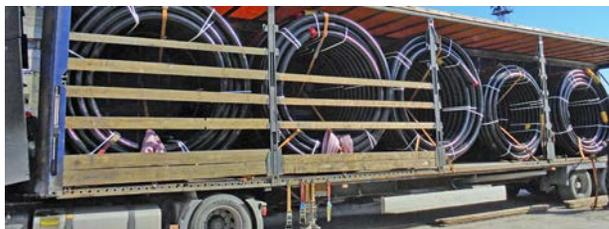
АТС, прибывшее на погрузку должно быть чистым, с чистым тентом, как с внешней стороны, так и внутри прицепа/полуприцепа. Борта в кузове автомашины должны иметь высоту и прочность, необходимую для удержания готовой продукции от поперечного перемещения или от раскачивания при движении. Транспортное средство не должно иметь в кузове выступающие части (распорки, уголки), имеющие при стандартной схеме загрузки непосредственный контакт с материалом и способные нанести ему ущерб при транспортировке.
