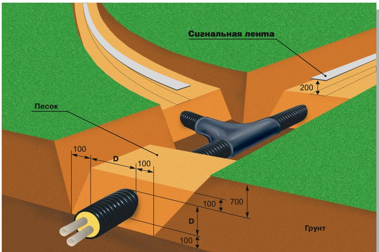
Удалить из траншеи твердые включения (камни, комья) и строительный мусор.
