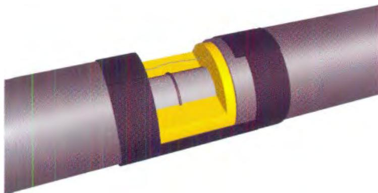
Гидроизоляция стыка производится после теплоизоляционных работ.
